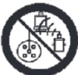
Installer loin de la bobine d'allumage et passer le câblage loin des câbles de haute tension.
